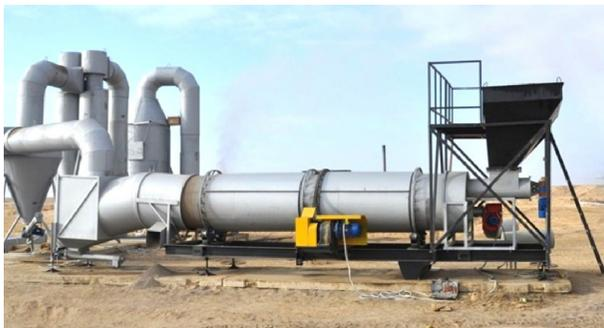
Рисунок 51 — Установка термической обработки отходов
