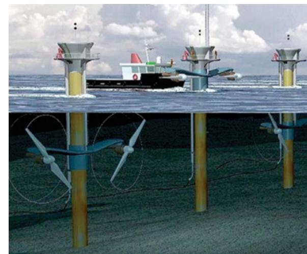
Рисунок 4 — Генератор приливного потока
